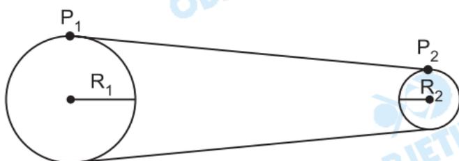
Para polias ou engrenagens em contato direto ou ligadas por uma correia ou corrente, a velocidade linear dos pontos periféricos é a mesma:
