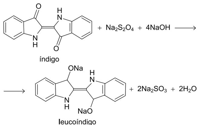
A indústria têxtil gera muitos efluentes contaminados com o leucoíndigo. Essa substância pode ser removida da solução resultante por eletrólise, recuperando o índigo insolúvel.
