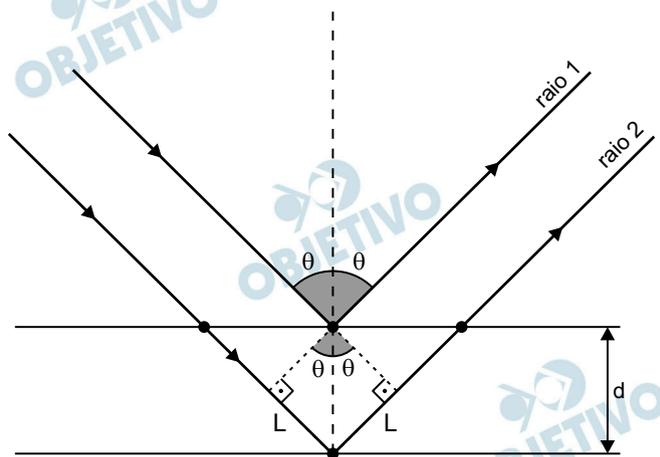
Para a interferência construtiva dos raios x, a diferença de percurso entre os raios 1 e 2 deve ser múltipla inteira do comprimento de onda  $\lambda$  do feixe:
