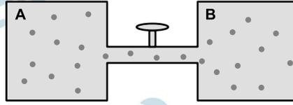
Inicialmente o gás em A está na temperatura  $T_A$  sob pressão  $P_A$  e em B, na temperatura  $T_B$  sob pressão  $P_B$ . A válvula é então aberta até que as pressões finais  $P_{Af}$  e  $P_{Bf}$  alcancem a proporção  $P_{Af} / P_{Bf} = \alpha$ , mantendo as temperaturas nos seus valores iniciais. Assinale a opção com a expressão de  $P_{Af}$ .
